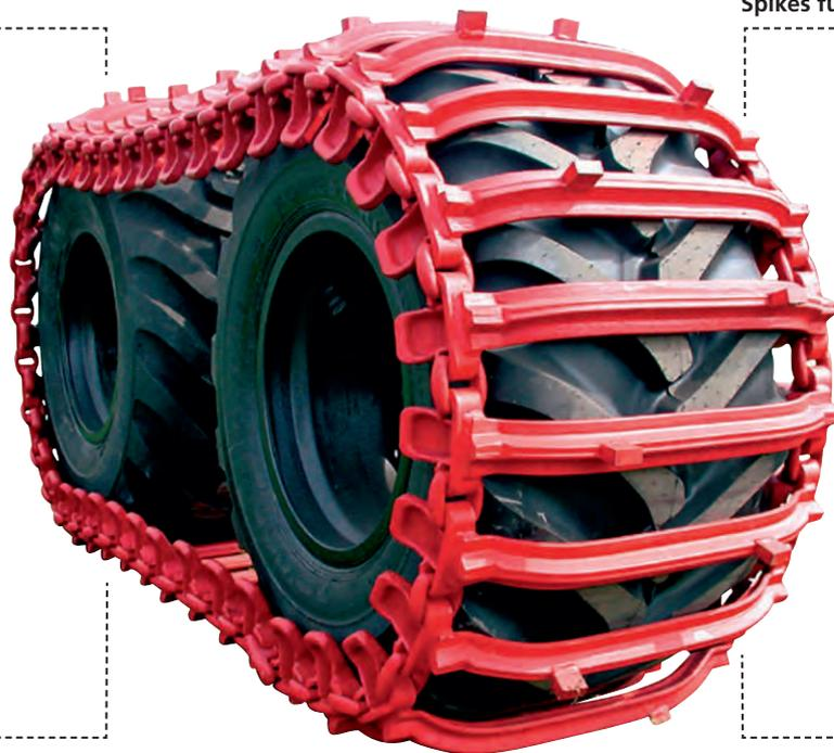
Reifenschutz durch optimale Anpassung an das Reifenprofil. Lange Lebensdauer durch hochwertigen Borstahl, optimale Härtung und starke Gelenke.
