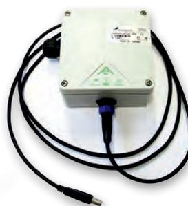
Combox zur Datenübertragung an den Fahrzeugcomputer bzw. Androidendgerät für 12 und 24 Volt Bordnetz geeignet
