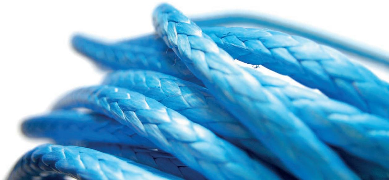
Das KOX Rückeseil Timberline besteht aus Dyneema®-Fasern. Dank seines verdichteten Aufbaus (thermisch gereckt) und der Imprägnierung ist es für den harten Rücke-Einsatz besonders geeignet. Timberline hat bei gleichem Durchmesser höhere Mindestbruchkräfte und nur 1/10 des Gewichts eines Stahlseils! Besonders bei der Seilarbeit am Hang werden Sie es nicht mehr hergeben wollen.
