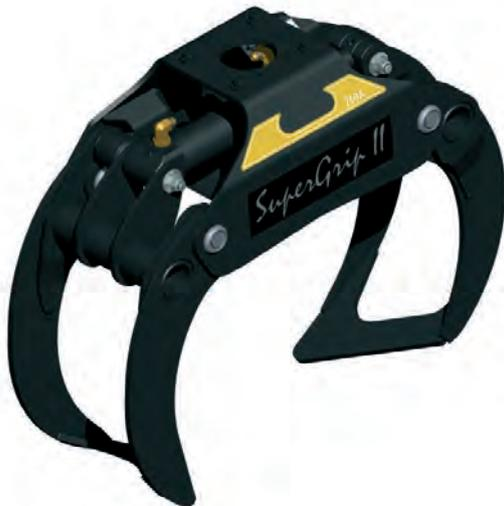
A-Greifer sehen sehr ungewöhnlich aus. Ihre Klauen enden in einer Spitze. Das bringt eine enorme Leistungssteigerung bei der Holzaufnahme am Hang. Das ist besonders empfehlenswert für Hangforwarter und LKW die Seilkranholz laden. Weniger geeignet sind die Greifer für 2m Holz. Die A Greifer haben verstärkte Klauen und 360-A und 420-A auch ein verstärktes Oberteil.
